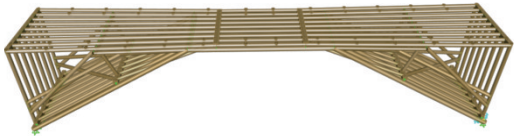
图 9 第 3 跨廊桥主拱模型
