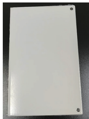
图3 喷涂光催化涂层后的搪瓷钢板试件
