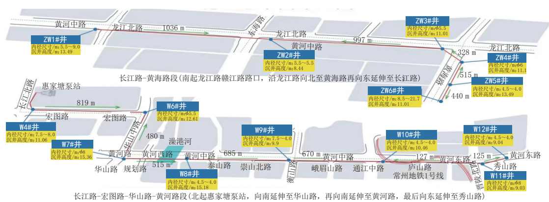
图1 顶管施工总体一览表
