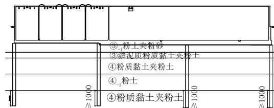
图4 搅拌桩围封剖面图(单位:mm)
