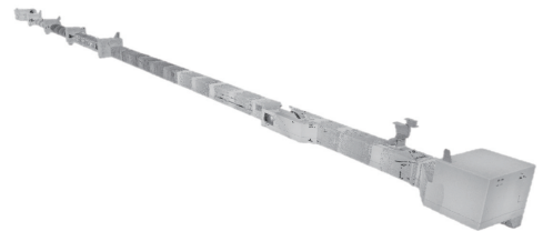
图8 综合管廊的完整点云数据
