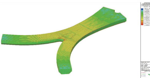
图 5 整桥应力俯视云图(单位:MPa)
