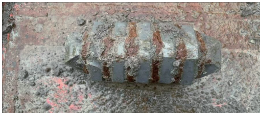
图 14 撕裂刀轻微磨损
