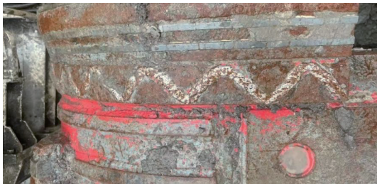
图 15 刮刀合金严重磨损
