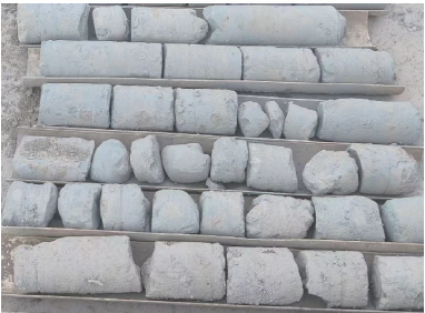
图8 MJS工法加固取芯
