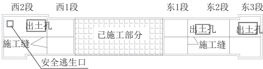
图8 基坑施工段划分图
