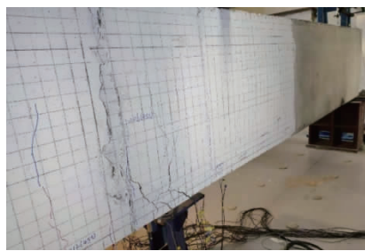
图8 3号试件裂缝图
