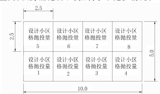
图4 抛投标准区格及小区格示意图(单位:m)
