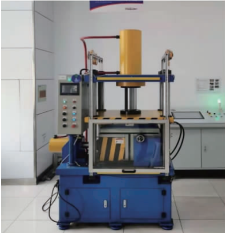
图 4 耐水压试验平台
