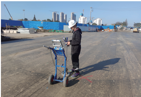
图4 现场采用 PFWD 测量动态模量 E_{vd}
