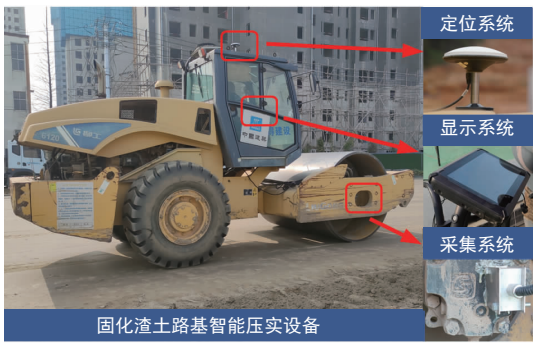
图2 固化渣土路基智能压实设备示意图
