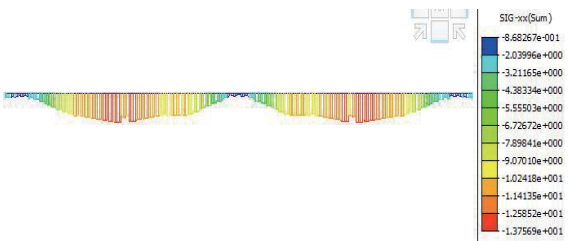
图 16 频遇组合效应下缘最小正应力图
