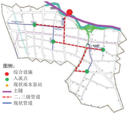
图 2 A 系统现状及二、三级管道示意图
