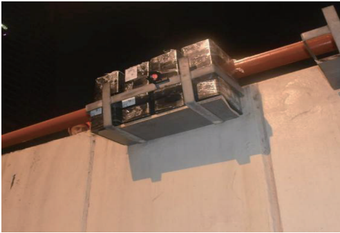
图 7 花盆托架加载现场图
