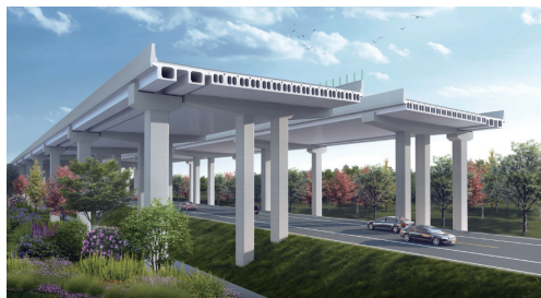
图2 主线空心板拼宽断面
