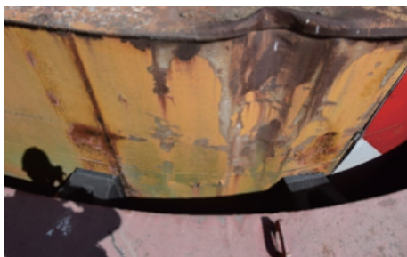
(b) 外侧板变形,变形面积约 1.8\text{ m}^2
