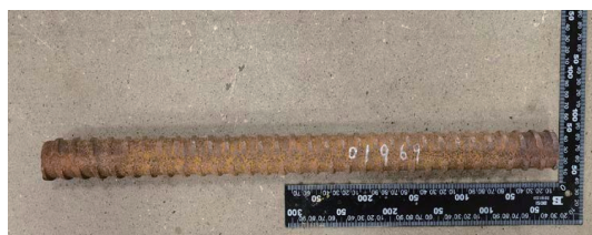
图4 断裂钢筋试样外观
